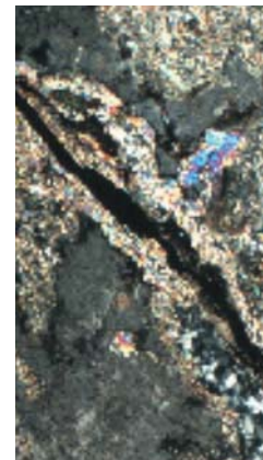
Ce granite est très altéré et a subi de nombreuses altérations physiques et chimiques, jusqu'à changer la structure physique du matériaux : présence de fissures, présence de minéraux généralement non constitutif d'un granite.
